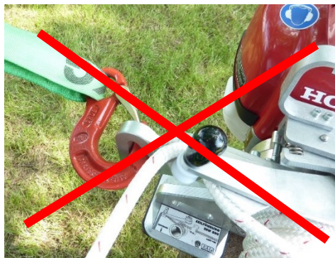
Bild 6: Felaktig fastsättning av EDER Powerwinch
