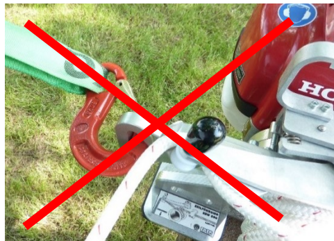
Rys.6: Niewłaściwe mocowanie wyciągarki EDER Powerwinch
