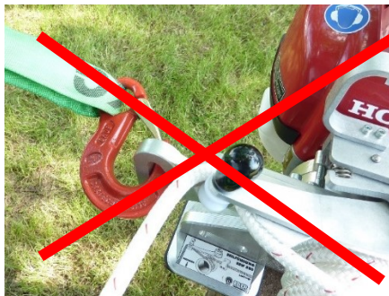
Fig. 6: Feil festing av EDER Powerwinch
