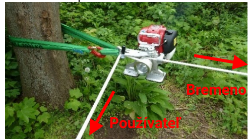
Obr.4: Zariadenie EDER Powerwinch 500 v pracovnej polohe
