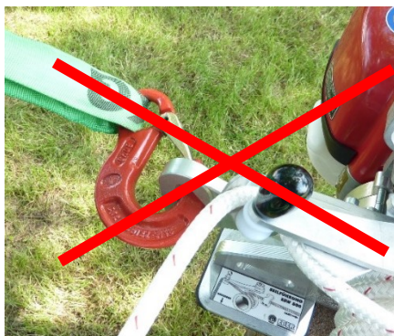
Fig. 6: Fixation incorrecte du Powerwinch 500 EDER
