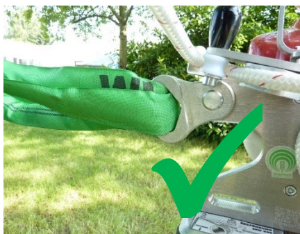
Fig. 7: Fixation correcte du Powerwinch 500 EDER
