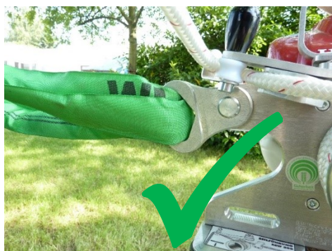
Bild 7: Rätt fastsättning av EDER Powerwinch
