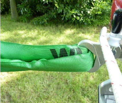
Abb. 5: Seilführung durch die Seilklemme
