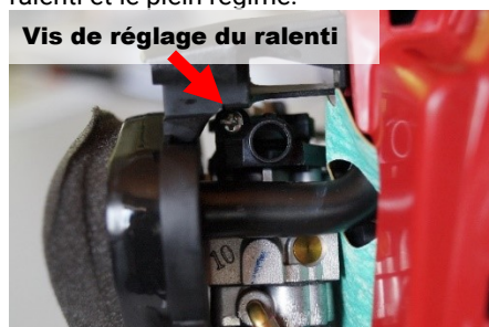
Fig. 11: Réglage du ralenti
