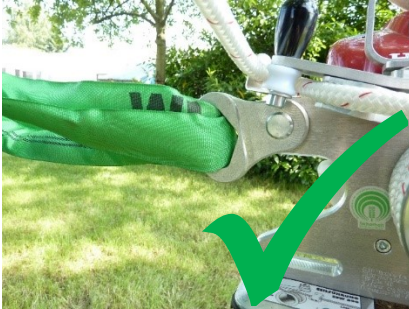
Rys.7: Prawidłowe mocowanie wyciągarki EDER Powerwinch
