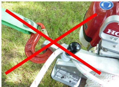
Obr. 6: Nesprávné upevnění navijáku EDER Powerwinch
