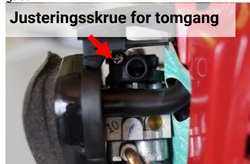
Fig. 11: Justering av tomgang
