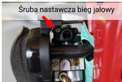
Rys.11: Ustawianie biegu jałowego
