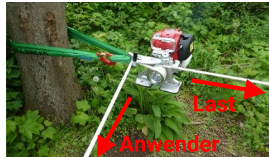
Abb. 4: EDER Powerwinch 500 in Arbeitsposition
