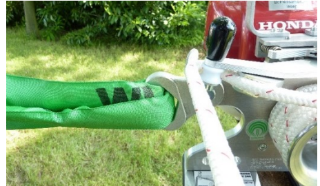
Rys. 5: Prowadzenie liny przez zacisk linowy
