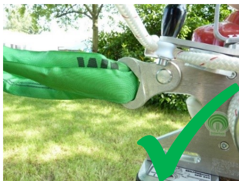
Obr. 7: Správné upevnění navijáku EDER Powerwinch
