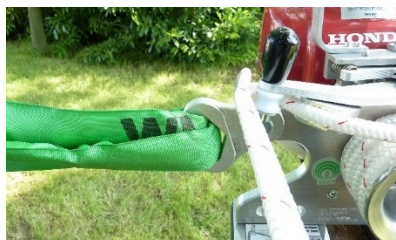
Fig. 5: Passage de la corde par le serre-corde
