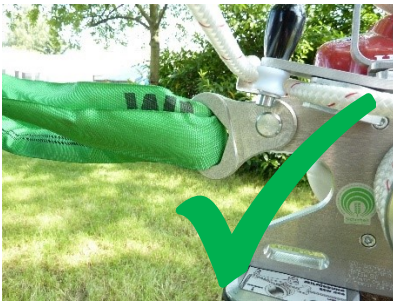
Obr.7: Správne upevnenie zariadenia EDER Powerwinch
