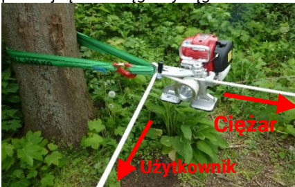
Rys. 4: Wyciągarka EDER Powerwinch 500 w pozycji roboczej
