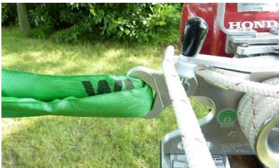
Fig. 5: Tauføring gjennom tauklemmene
