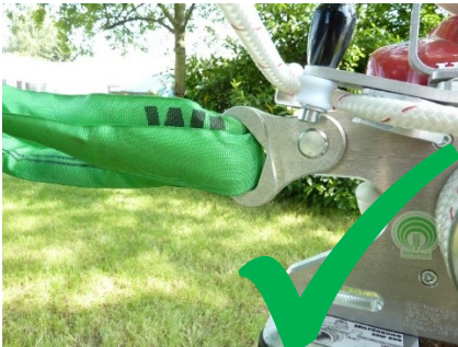
Abb. 7: Richtige Befestigung der EDER Powerwinch
