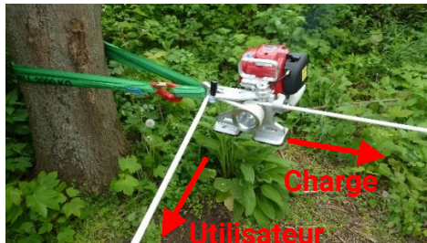
Fig. 4: Le Powerwinch 500 EDER en position de travail
