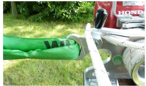
Obr.5: Vedení lana lanovou svorkou
