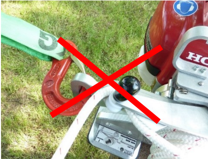
Abb. 6: Falsche Befestigung der EDER Powerwinch
